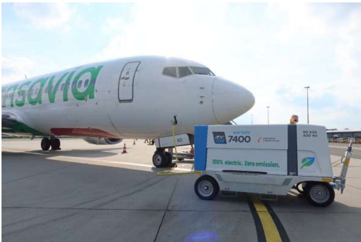
De nieuwe batterij-elektrische ground power unit (GPU) als stroomvoorziening voor vliegtuigen.
